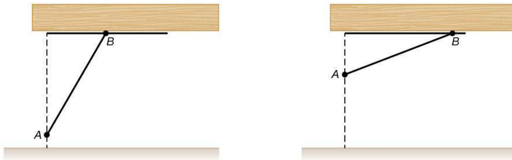
figuur G.13 Tijdens het openen schuift A omhoog en B naar rechts.
